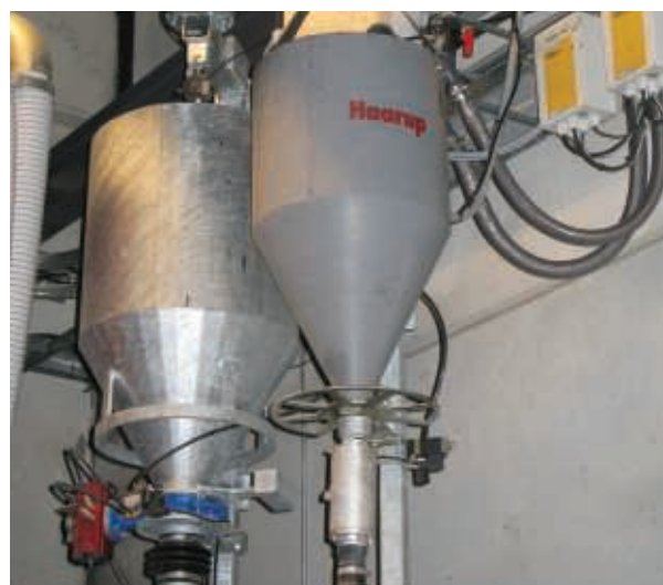
Slurry-farve- og vandvægt med ind- og udløbsventiler.
