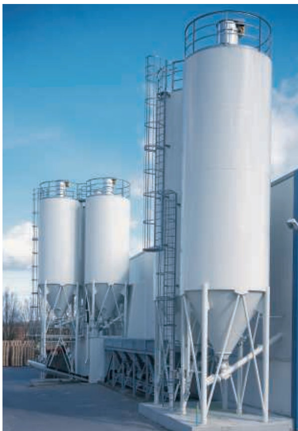
Cementsiloer med galvaniseret lejder, gelænder og filter med trykluftafrensning.
