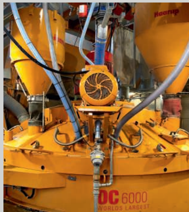
Trykforøgerpumpe for mellemrengøring af blanderen.
