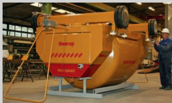
3500 liter duo-speed betontransportvogn kontrolleres før levering.
