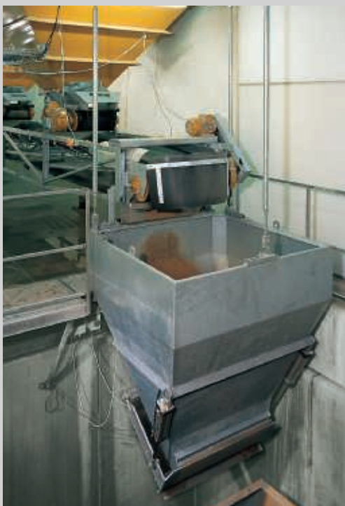
Kombi-vejesystem med gittervejbånd og vejesilo.
