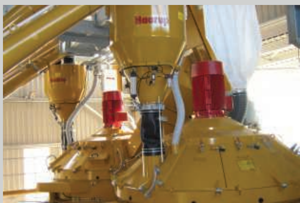
Cementvægte ophængt i elektroniske vejeceller.
